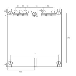
Vue de l'arrière du boitier montrant les trous de fixations
