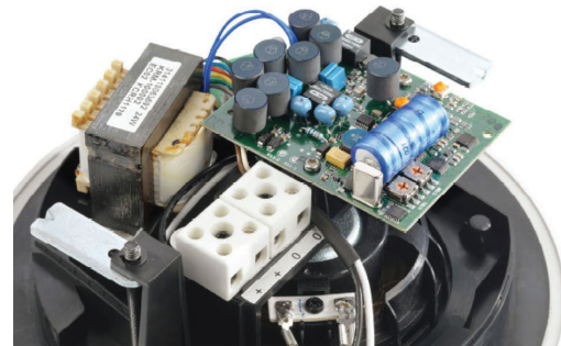
Vue arrière du LC4-UCxxE avec montage en option de la carte de surveillance de ligne
