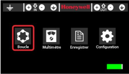
L'appareil reconnaît les senseurs et les modules de la boucle avant d'alimenter le central de détection d'incendie (FACP). Le POL-200-TS est compatible avec CLIP (Classic Loop Interface Protocol) avec 99 senseurs et 99 modules et le nouveau protocole Advanced ou Opal avec jusqu'à 159 senseurs et 159 modules.
