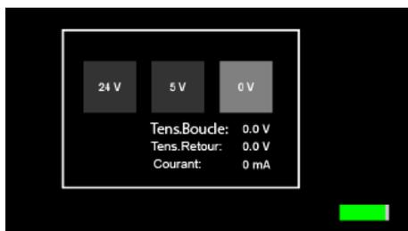
La lecture 24V fournit une chute de tension de référence dans la boucle, un V retour inférieur à 17Vdc indique que la résistance est trop élevée dans la boucle.
