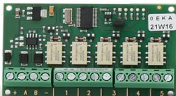
**auxi relais** dispose de 5 sorties relais de 1A qui peuvent être utilisées dans les centrales de la série **lares** pour la gestion de tout type de charge. Chaque sortie peut être programmée en NC, NA, Bistable ou Monostable, avec un temps d'activation programmable.
