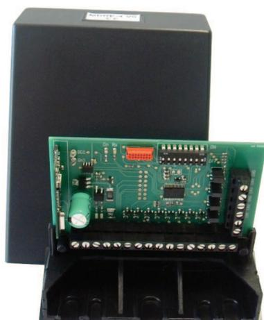
Évolution du MRRE, le **MRRE-4** est un récepteur radio 433MHz multiprotocole à 4 canaux pour contrôle d'accès.
