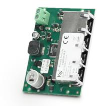
switch 4.0 est un commutateur réseau 10 / 100Mbit conçu pour connecter les centrales lares 4.0 avec les modules IP (ergo-T / ergo-T plus, gemino IoT, porta, etc.) de Ksenia Security.
