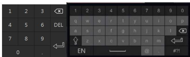
Le système comprend deux dispositions d'entrée du clavier comme illustrent les photos ci-dessus. La case de gauche est le clavier d'entrée numérique et la case de droite est le clavier d'entrée général qui fournit des entrées de nombres, de lettres et caractères de ponctuation comme indiqué ci-dessous
