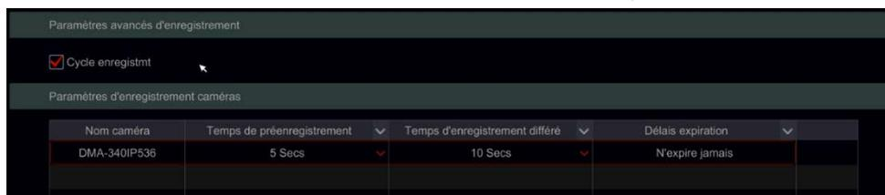
**Temps d'enregistrement pré-alarme** : Réglez la durée du temps d'enregistrement avant le début de l'événement d'alarme.
