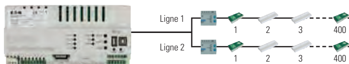
Installation typique max. 4 lignes de 200 blocs autonomes chacune (ci-dessus) ou deux lignes de 400 blocs chacune (ci-dessous).
