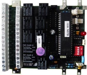
La centrale CMSI est composée, dans sa configuration de base, d'un boîtier équipé d'une alimentation électrique NF EN 54-4 et de la carte fonction/gestion/afficheur permettant la programmation et l'exploitation du système.
