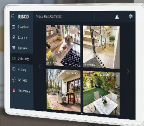
RisControl est un clavier à écran tactile 8" haute résolution, qui offre une interface utilisateur intuitive facile à utiliser. Avec RisControl, l'utilisateur peut contrôler son système d'alarme et les solutions Cloud de RISCO Group depuis un point d'accès. Il fournit un aperçu clair de l'état du système, les fonctionnalités d'armement et désarmement et l'option de visionner des vidéos en direct et des enregistrements depuis la solution Vidéo VUpoint.
