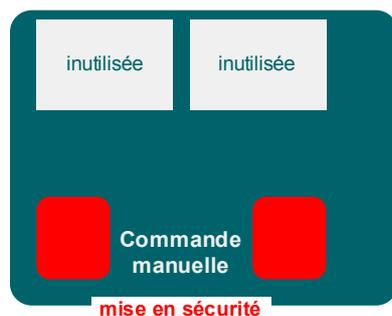
**Identification de la zone** : cette zone initialement libre permet d'apposer une étiquette détaillant la fonction réalisée.
