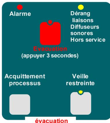
**Alarme** : l'évacuation est ou a été commandée par la détection automatique. On parle alors de processus automatique.
