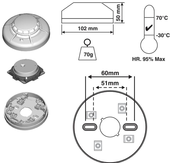
Figure 1 : Raccordement des Socles
