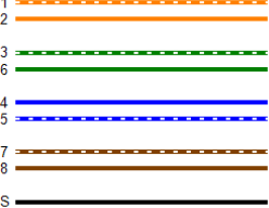
Schéma de câblage (T568B)
