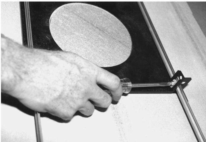
**Figure 4.4** Serrage des vis de fixation du support
